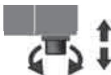
Sistemare il murale refrigerato in posizione perfettamente verticale, agendo se necessario sulla regolazione dei piedini a vite delle gambe del murale per regolarne il livello verificare la planarità con una bolla.
