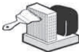
Tutte le operazioni di pulizia sia del murale refrigerato che del moblocco refrigerante o dell'unità condensatrice incorporata devono essere eseguite con unità ferma, togliendo la tensione elettrica.
