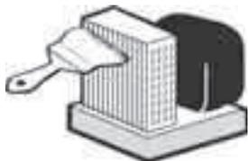
**Tutte le operazioni di pulizia sia della MINICELLA frigorifera che del monoblocco refrigerante o dell'unità condensatrice incorporata devono essere eseguite con unità ferma, togliendo la tensione elettrica.**
